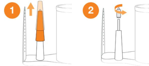
Wenn nicht, dann tauschen Sie den Dichtring aus und schrauben Sie das neue Kopfventil auf die Ventilstange und stülpen Sie den Glasschutz über das Kopfventil.
